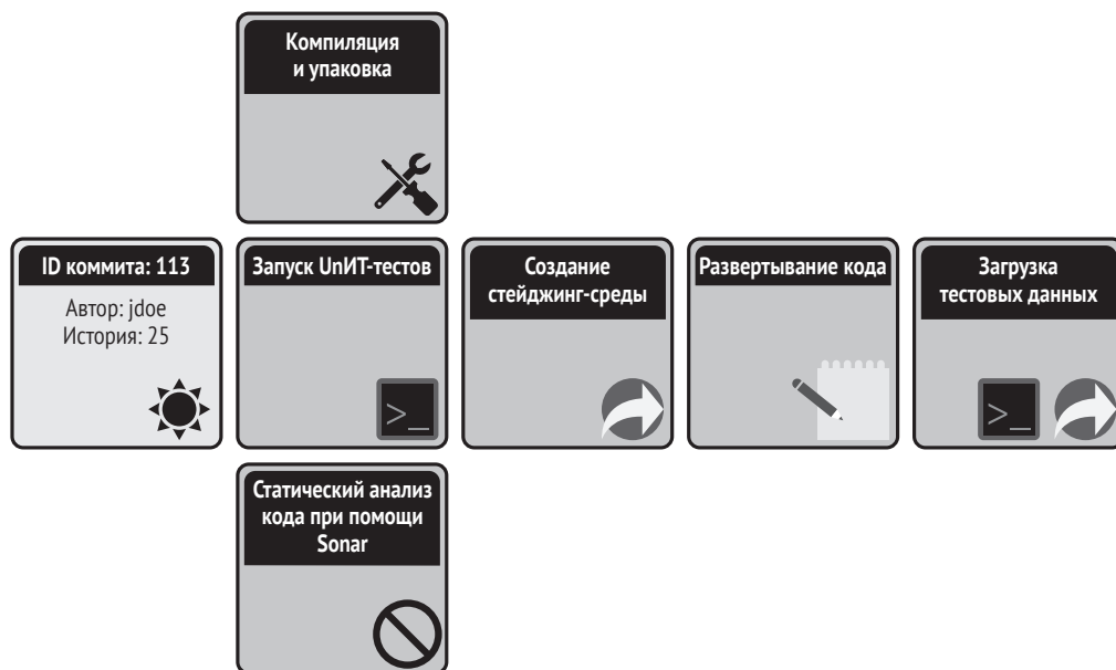
Рис. 1.3. Пример конвейера развертывания: DevOps-платформа Accenture предоставляет возможность наблюдать за процессом развертывания
