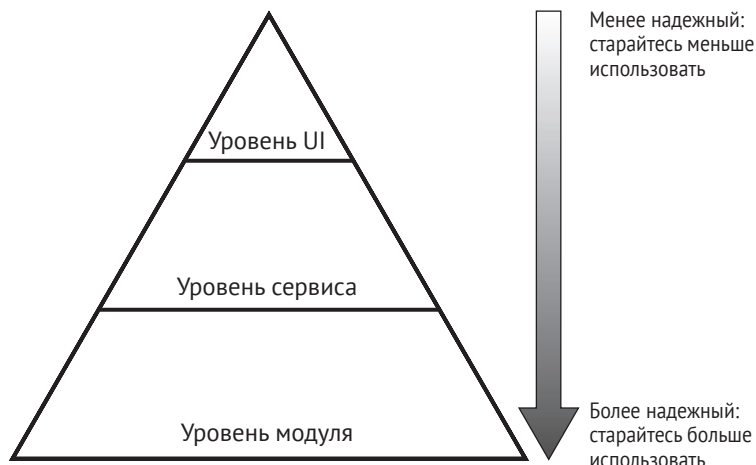
Рис. 7.2. Пирамида автоматизации тестирования. Чем медлительнее уровень, тем меньше мы будем его использовать при автоматизации
